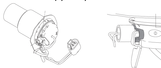
Рис. 913 Правильно установленный штифт накала
